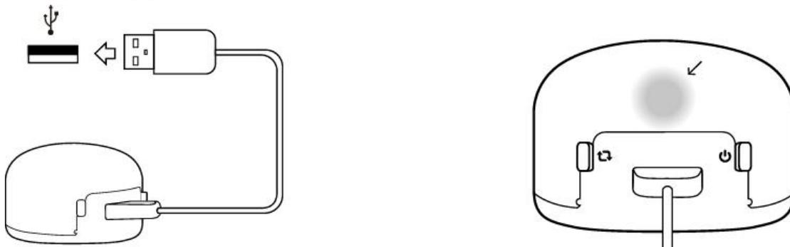
将 USB 线的一端插入 MU 主机后方的 USB 口，另一端插入标准 USB 接口，即可充电。如图所示，充电时充电指示灯会点亮。充电完成后，充电指示灯会自动熄灭。
